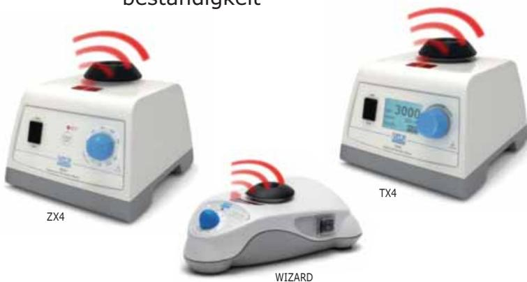
Vortexer mit patentiertem IR-Sensor zur Probenerkennung: der Schüttelvorgang startet automatisch, wenn das Probengefäß sich dem Vibrationsteller nähert. Dadurch wird ermüdungsfreies Arbeiten ermöglicht, da kein Druck auf das Gerät ausgeübt werden muss.
