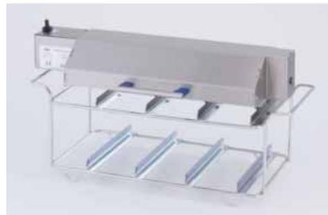
Siebreinigungsmodul aus Edelstahl mit integrierter Dreheinheit zur Reinigung von bis zu 4 Analysensiebe (Ø bis 200/203 mm) im Ultraschallbad. Die Schrägstellung der Analysensiebe im SRH 4/200 gewährleistet einen besseren Reinigungs- und Spüleffekt. Dadurch werden die Analysensiebe schonend und ohne Veränderung der Maschenweite oder Gewebespannung gereinigt. Maßgenauigkeit und Kalibrierung der Analysensiebe bleibt zu 100% erhalten.
