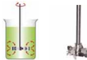
Der Dissolverrührer erzeugt ein radiales Strömungsbild mit hohen Turbulenzen.
