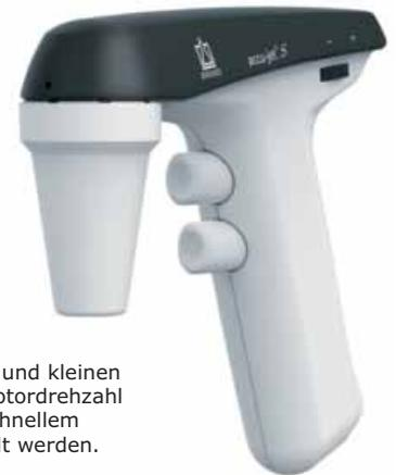
Für präzises Pipettieren von großen und kleinen Volumina. Durch die regulierbare Motordrehzahl kann zwischen freiem Ablauf und schnellem Ausblasen der Flüssigkeit gewechselt werden.
