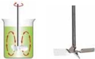
Der 4-flügelige Schrägblattrührer sorgt für ein axiales Strömungsbild und es entstehen bei höheren Drehzahlen zunehmend Scherkräfte an den Rührblättern.
