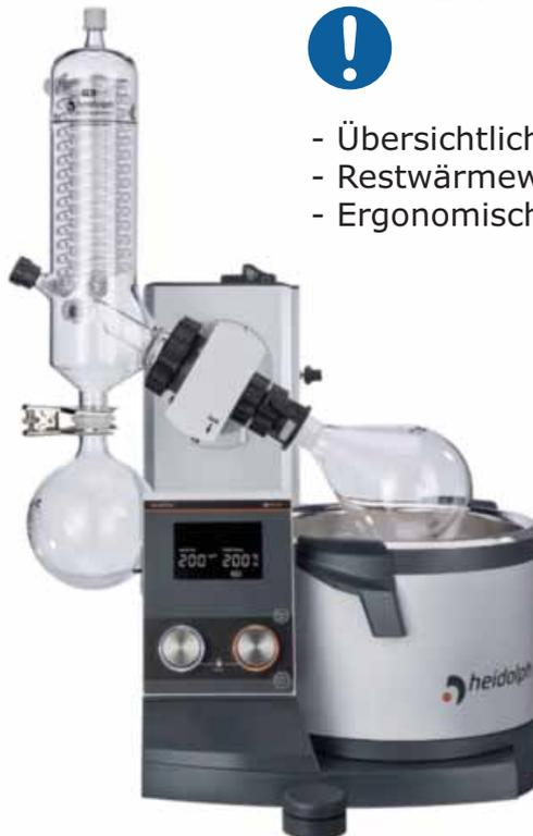
Ein auf das Wesentliche reduziertes Bedienkonzept: übersichtlich und jederzeit mit direktem Zugriff auf die Grundparameter Rotationsgeschwindigkeit und Heizbadtemperatur. Ohne Vakuumsteuerung. Zur Integration in ein bestehendes Vakuumsystem oder zur Konfiguration mit optionalem Vakuumregler.
